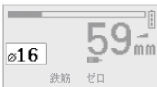
鉄筋寸法/径-ユーザ入力(24)
