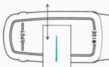
把左图的试样在计器上，上下、左右移动。分别用两个探程试探确认。
