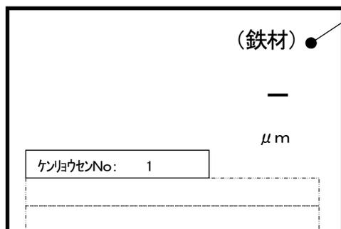
「Fe」シリーズのSWT専用プローブを接続し、本器が鉄系の素材の測定にセットされていることを示しています。
