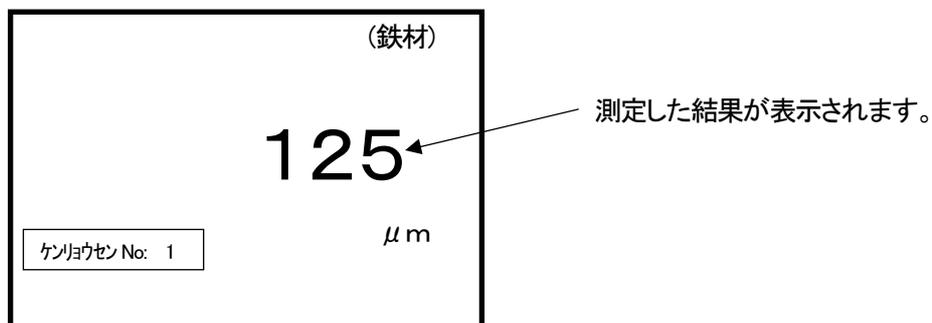
対象物にプローブを押し当てる都度、ブザーが「ピッ」と鳴って、測定した結果が表示されます。
