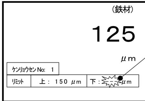
注: 上限の限界値が必要ないときには ▲ キーを押さずに H/L キーを押して下さい。「上: --- μm」の点滅は止まります。
