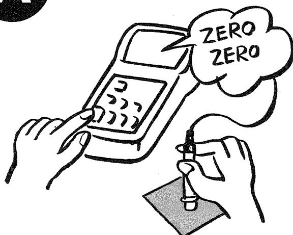
天秤の例で考えると、測定対象物の入れもの(風袋)の重さをあらかじめ測っておき、それを差し引いてやらなければ正しい中身の重さは測定できません。天秤による入れもの(風袋)の測定が膜厚計を使用する場合のZERO調整に相当します。ZERO調整は、測定する対象物の素地材質とできる限り同じ物を使用する必要があります。その理由は、素地の材質の違いや形状の違いが原因で、膜厚計の製造工程で組み込んだ「電流の変化→厚み」の変換データと異なってくるからです。「膜厚を測定する対象物の素地材質と、できる限り同じ物」でZERO調整することによって、初めてこの相異が正しく補正されます。
