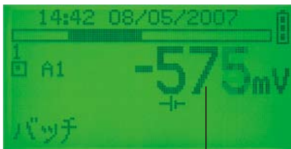
ハーフセル電位測定時
