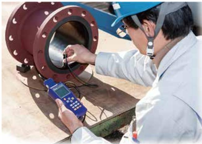
SWT 9000 シリーズは、プローブに互換性を持たせたことで、用途や測定対象物に適合する接続プローブを自由に選択できます。
