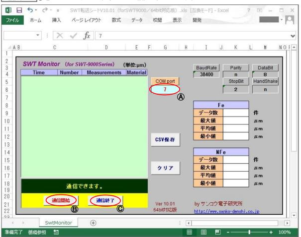
(注) パソコンと膜厚計が USB ケーブルで接続されていない場合や COM ポート番号の入力が間違っている場合に 通信開始 圏をクリックすると下記の警告が表示されます。パソコンと膜厚計を USB ケーブルで接続し、改めて COM ポート番号を確認してください。
