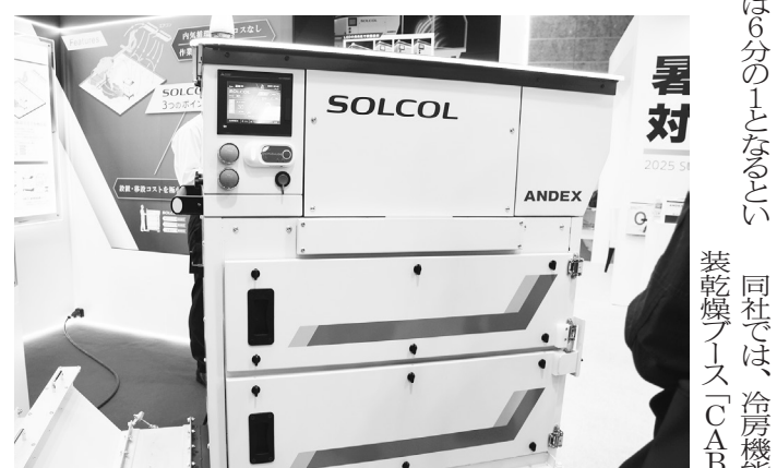
④密閉もラインを通す半密閉も可能で、冷房設置ができる⑤局所排気装置を必要としない溶剤除去装置「SOLCOL」
