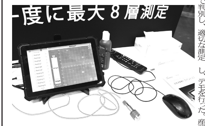
④専用プローブで測定素地金属を自動判別も可能な「SWT-NEO Series」⑤新製品の超音波式膜厚計「クイントニックT」。塗膜厚を最大8層まで非破壊で測定
